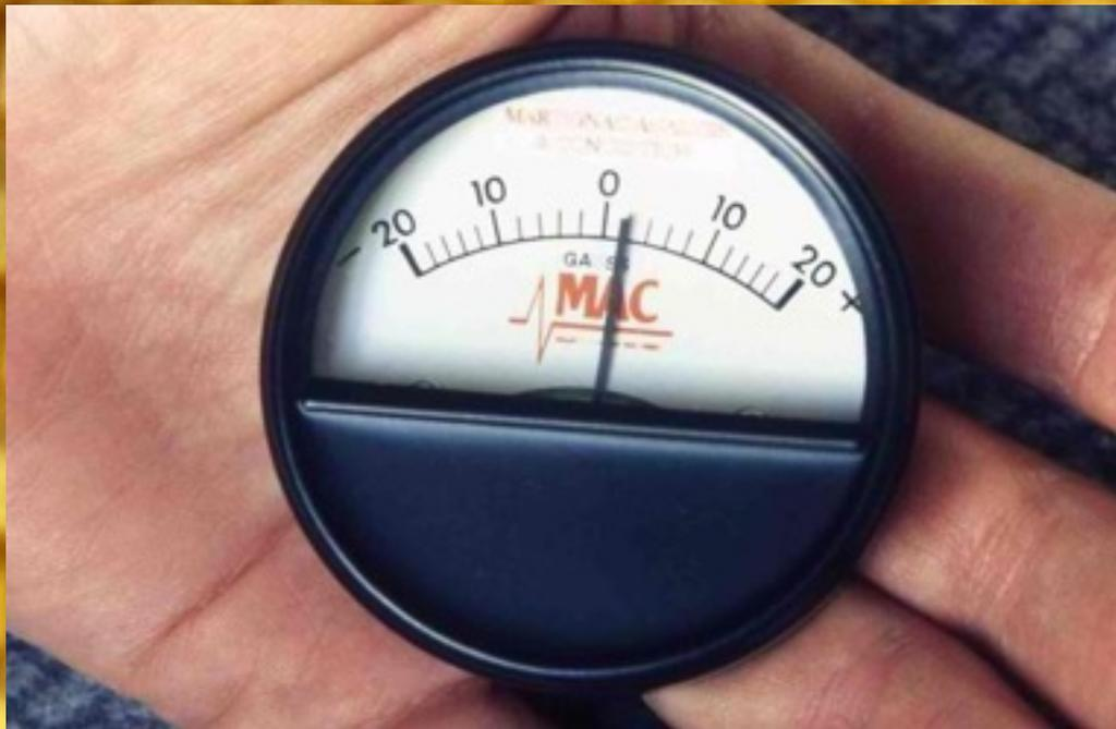
**Nous mesurons entre 8 et 10 Gauss au centre sur 15cm en bas et en haut de ce centre considéré. La mesure dépasse 20 Gauss largement en s'approchant des rives.**
